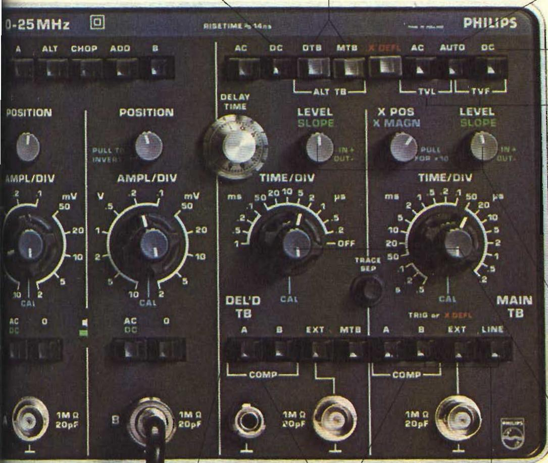
L'accoppiamento c.c. del trigger nella base dei tempi principale costituisce una caratteristica importante per le forme impulsive con ciclo di carico variabile.
